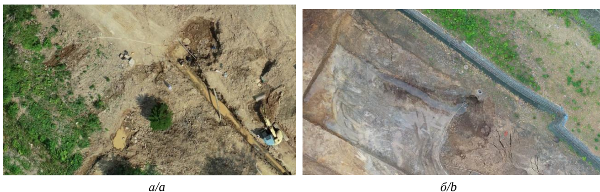
Рис. 4. Космоснимок с водопрооявлениями в сухую погоду: а) в 10 м выше по склону над наивысшей точкой бровки срыва оползня; б) в восточном углу углубленного котлована в подошве оползня
