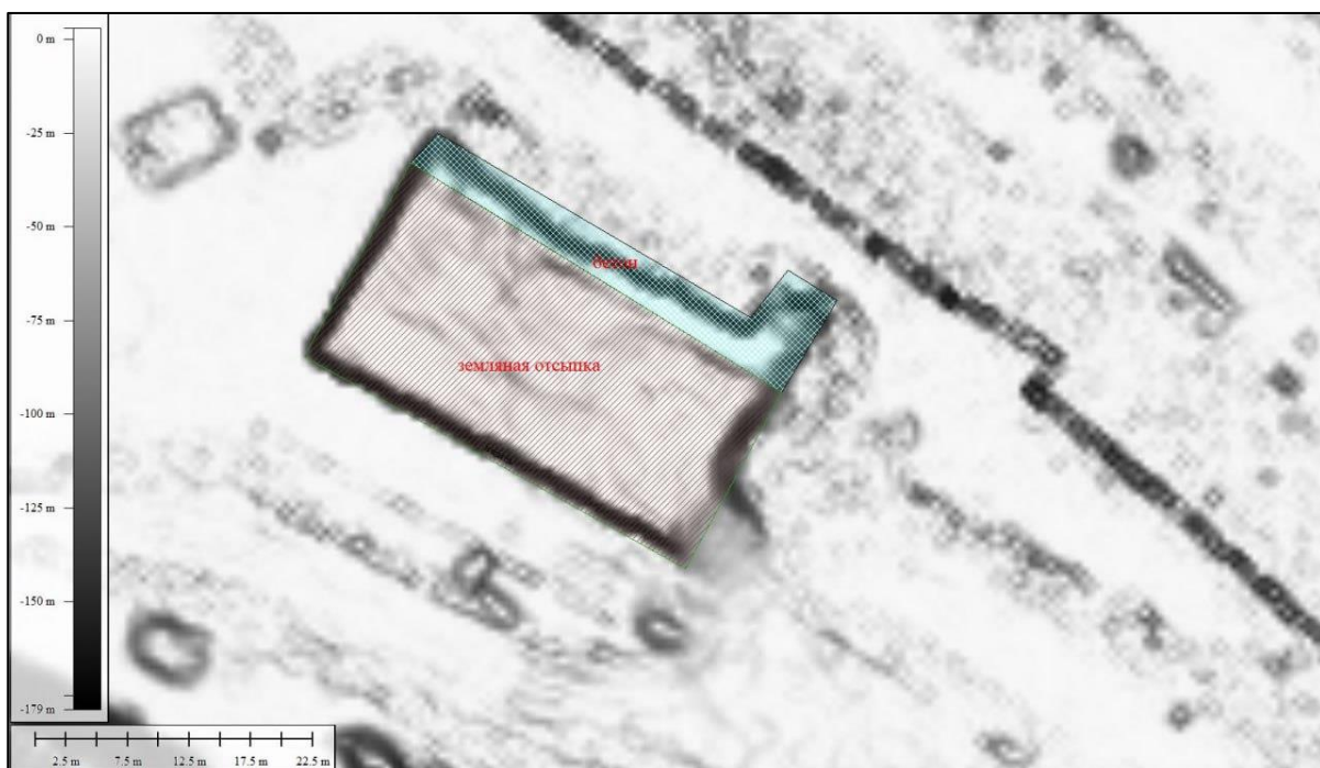
Рис. 14. ЦМР части котлована. Контроль обратной засыпки углубления, спровоцировавшего оползень. Голубой штриховкой обозначена бетонная заливка, коричневой – отсыпка грунтом
