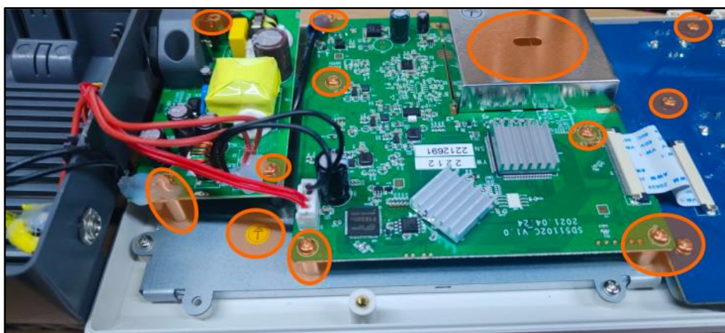
Рис. 7. Заземленные винтовые соединения осциллографа Fig. 7. Grounded screw connections of the oscilloscope
