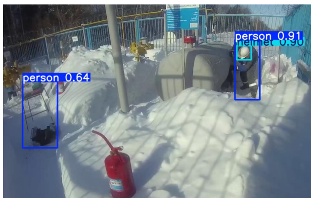
Рис. 4. Пример детекции объектов в кадре на объекте газотранспортной инфраструктуры
