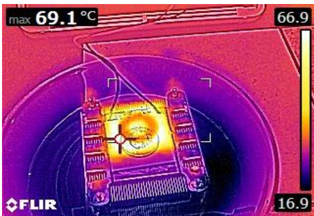
Рис. 6. Нагревание монеты на стенде (тепловизор) Fig. 6. Coin heating on the stand (thermal imager)
