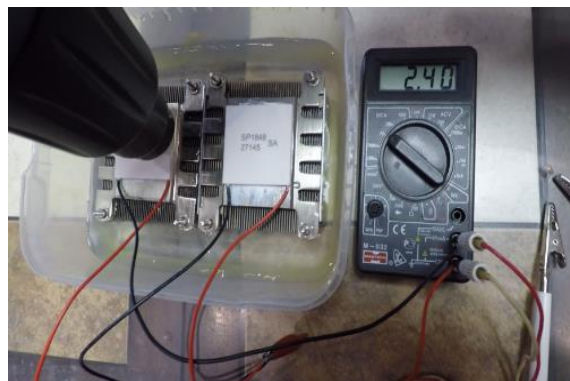
Рис. 7. Генерация энергии с помощью модулей Пельтье (два модуля)
