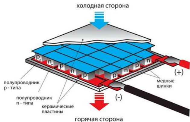
Рис. 1. Структура модуля Пельтье Fig. 1. Peltier module structure
