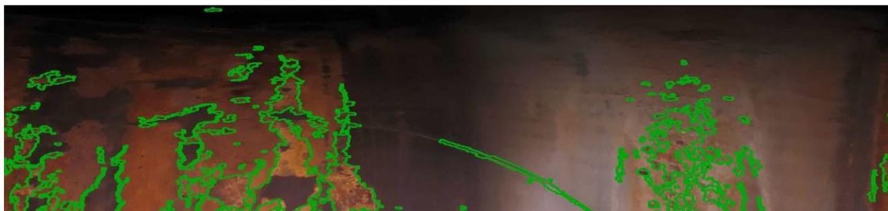
Рис. 3. Выделенные моделью U-Net области с дефектами
