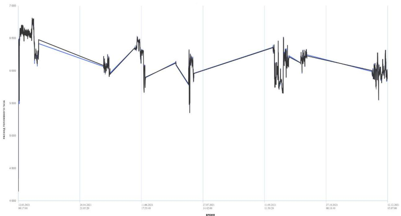
**Рис. 4.** Модель компрессорной установки: черный – исходные данные; синий – показания модели
