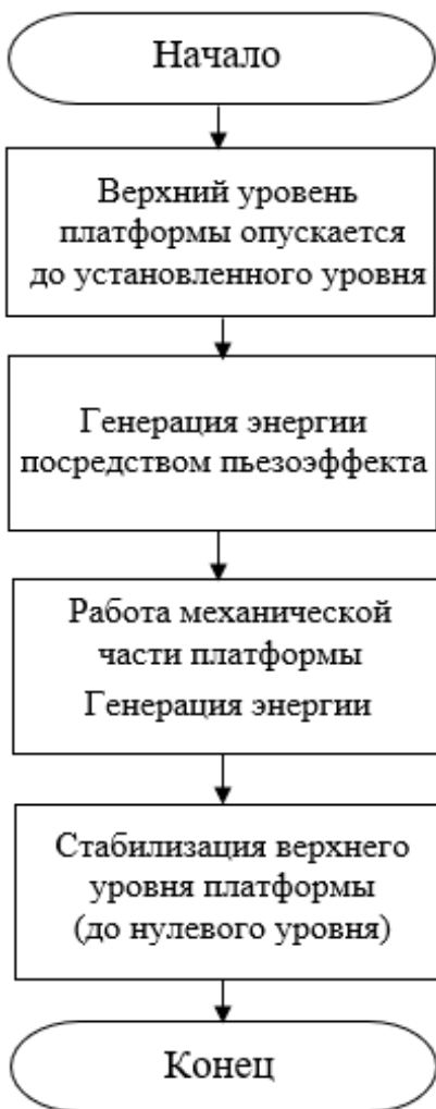
Рис. 4. Алгоритм работы платформы Fig. 4. Algorithm of platform operation
