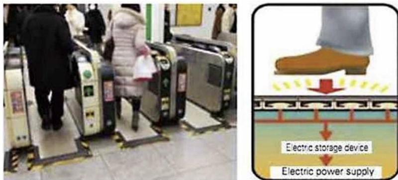
Рис. 2. Вид и местоположение платформы для генерации электроэнергии с помощью энергии шагов Fig. 2. Type and location of the platform for generating electricity using energy from steps
