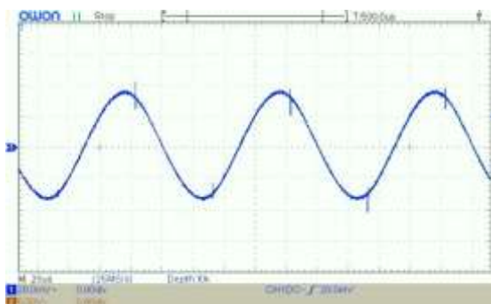
Рис. 17. Пульсации при уставке напряжения 5 В Fig. 17. Ripple at 5 V voltage setting
