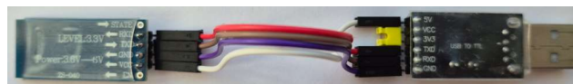
Рис. 4. Фото схемы подключения HC-06 к компьютеру Fig. 4. Photo of the HC-06 connection diagram to a computer
